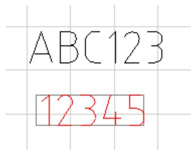
可能您建立的标记的位置跟我做的这个例子中的不一样，没关系，您可以使用键盘上的方向键移动最后建立的标记，每点击一次方向键，标记的位置将按您移动的方向移动 1mm。在移动的过程中，您可以注意刻印机头的刻印针，刻印针将随“12345”位置的改变而移动，这是软件的一大功能，每次您改变标记的位置时，刻印针都会自动对准到新的标记位置。
