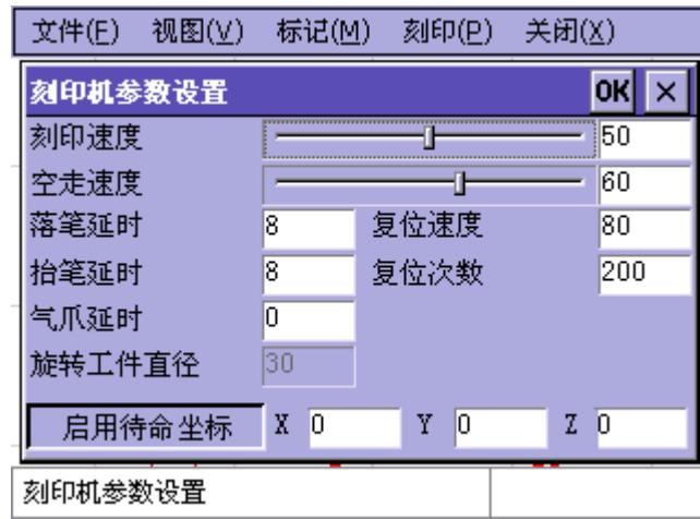
“刻印速度”是指刻印针在刻印状态时行进的速度，“空走速度”是指刻印针在非刻印状态时行进的速度（即空走），正确设置与搭配这两个速度，可在不影响精度的情况下达到高效刻印。一般情况下，空走速度可以高于刻印速度，但最好不要高于 20 以上。
