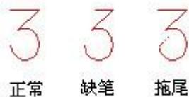
在开始刻印每一个字符的每一连续的笔画时，高压气源会被打开，从而带动刻印针高频冲击并刻印，但由于高压气体在充气时需要短暂的时间，如果在这个时间段，刻印针已经开始刻印，而高压气体还未到达，就会出现缺笔现象。为了避免这种情况的产生，在高压气源打开后，让刻印针原地停顿一小段时间等待高压气体的到达，这样就可以有效的避免产生缺笔现象。这一小段停顿的时间我们简称为“落笔延时”，一般情况下大约只需 2-8 毫秒。
