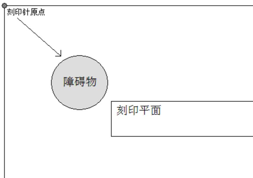
创建绕行点的方法很简单，在标记类型列表中选择[绕行点]，然后将此点移动到需要绕行的位置即可，如下图所示：
