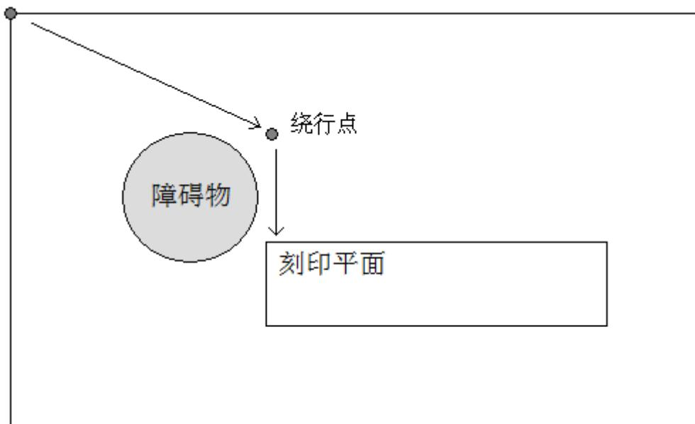
现在当刻印开始时，刻印针会按箭头所示的方向，先行走到“绕行点”，然后再行走到刻印平面，从而绕开障碍物。
